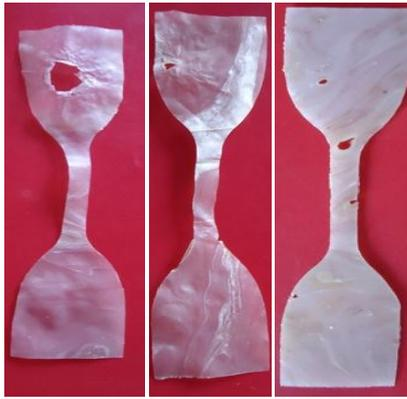
Gambar 9. Hasil pengamatan uji *burial test* plastik *biodegradable* (bagian yang dilingkari adalah lubang akibat degradasi pati oleh mikroorganisme)
