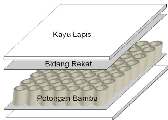
Gambar 1. Struktur Produk Panel Sandwich dari Bambu
