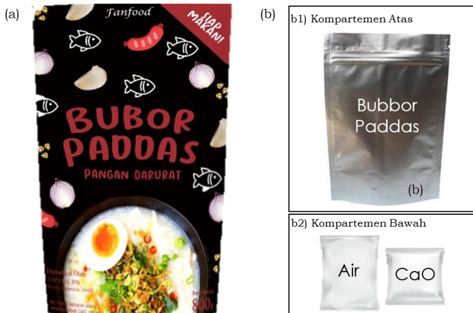
Gambar 1. Rancangan kemasan exotherm reaction-self heating dengan kalsium oksida dari cangkang kerang darah untuk pangan darurat lokal bubbor paddas. (a) Tampak kemasan bagian luar, (b) Kemasan isi, b1) Kompartemen atas berisi kemasan makanan, b2) Kompartemen bawah berisi kemasan untuk air dan pemanas eksotermik kalsium oksida
