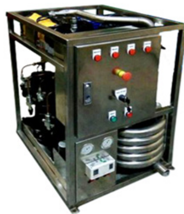
Gambar 3. Prototipe Slurry Ice Machine /Mesin Pembuat Bubuk Es (MPBE) metode scraped-surface
