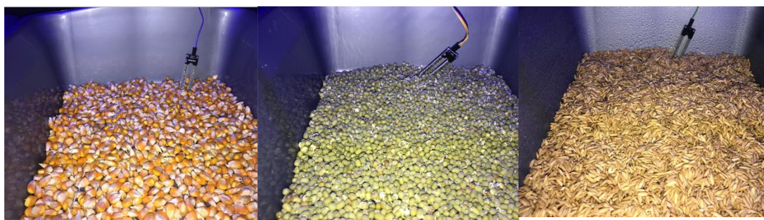
Gambar 1 Pemasangan sensor kelembaban pada masing-masing hijauan (a) jagung, (b) kacang hijau, (c) gabah
