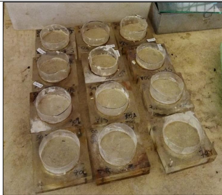
Gambar 1. Benda uji yang sedang dicetak dan dirawat
