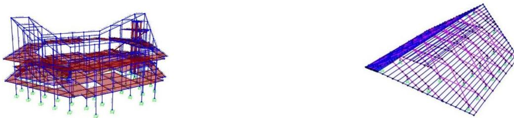
**Gambar 1.** Hasil pemodelan 3D Gedung Auditorium FEM (a) struktur utama, (b) struktur atap.
