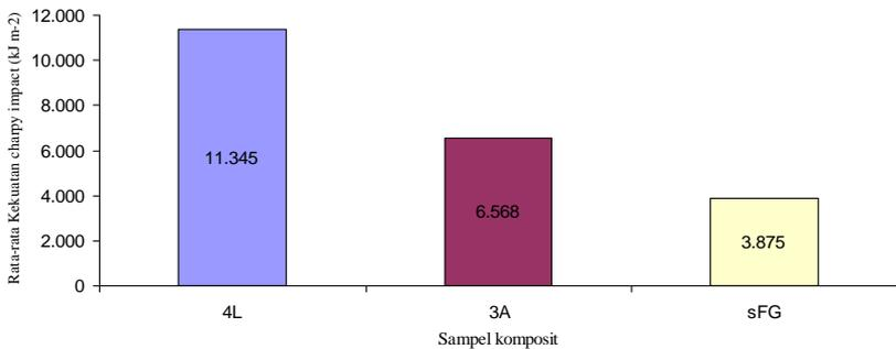
Gambar 4 Hubungan antara rata-rata *charpy impact* ( $\text{kJ m}^{-2}$ ) terhadap sampel komposit.
