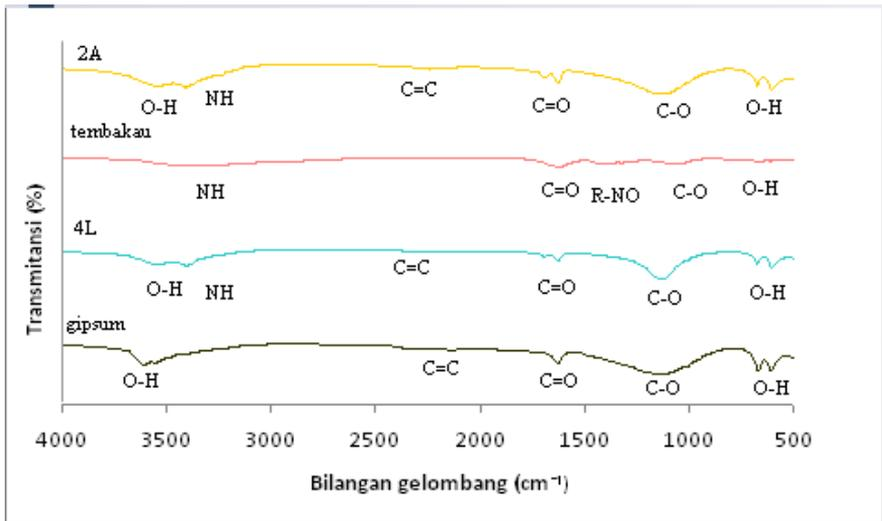
Gambar 7 FTIR biokomposit papan gipsium plafon.
