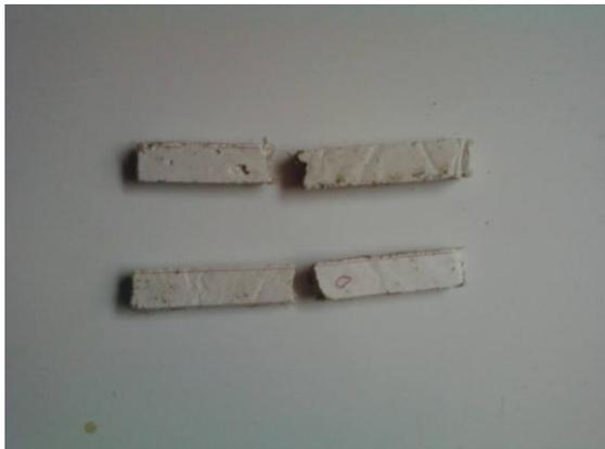
Gambar 5 Hasil pengujian *charpy impact*
