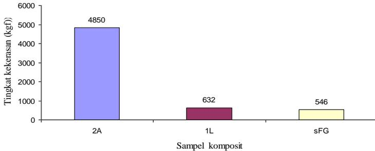
Gambar 1 Hubungan antara tingkat kekerasan (kgf) terhadap sampel komposit.
