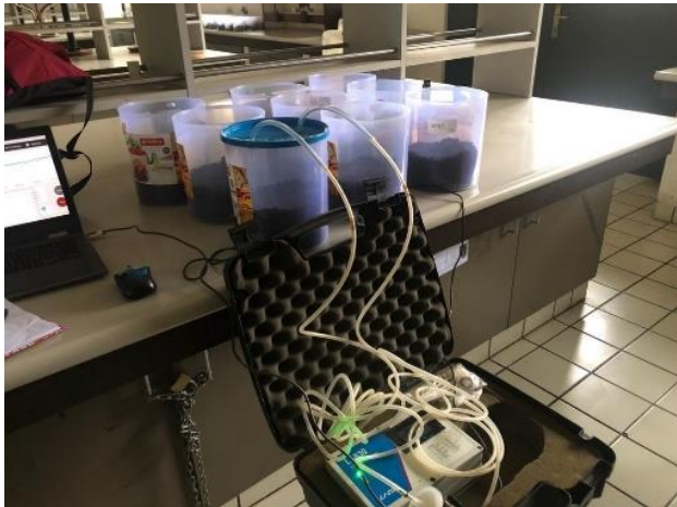
Gambar 1 Pengukuran CO 2 gambut dalam toples menggunakan Infrared Gas Analyzer Li-COR 830.
