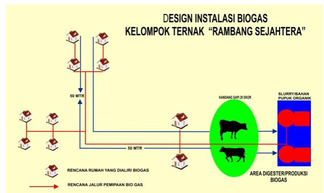
Gambar 4 Desain instalasi biogas
